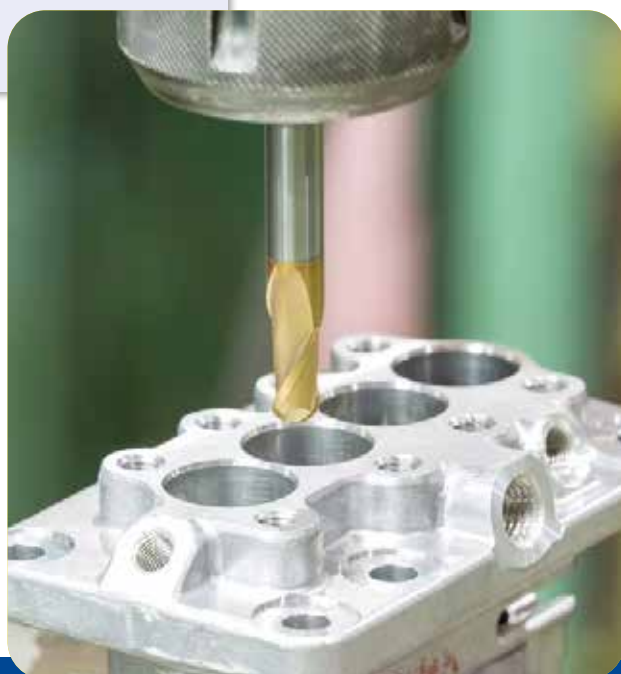
Perçage de centrage sur alliages légers au silicium, série 4000 (aluminums de fonderie).
